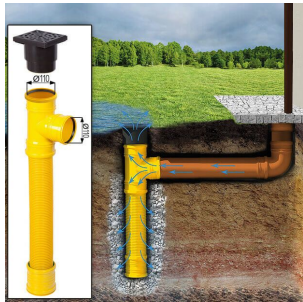
Sickerschacht mit Zufluss/Abfluss Ø 110 mm
