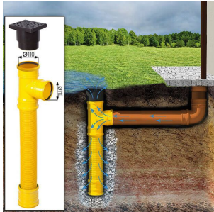
Sickerschacht mit Zufluss/Abfluss Ø 110 mm
