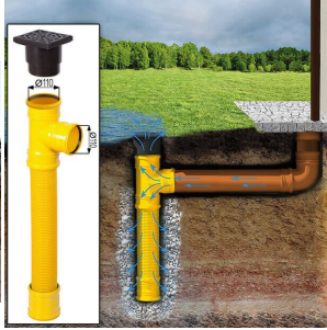
Sickerschacht mit Zufluss/Abfluss Ø 110 mm
